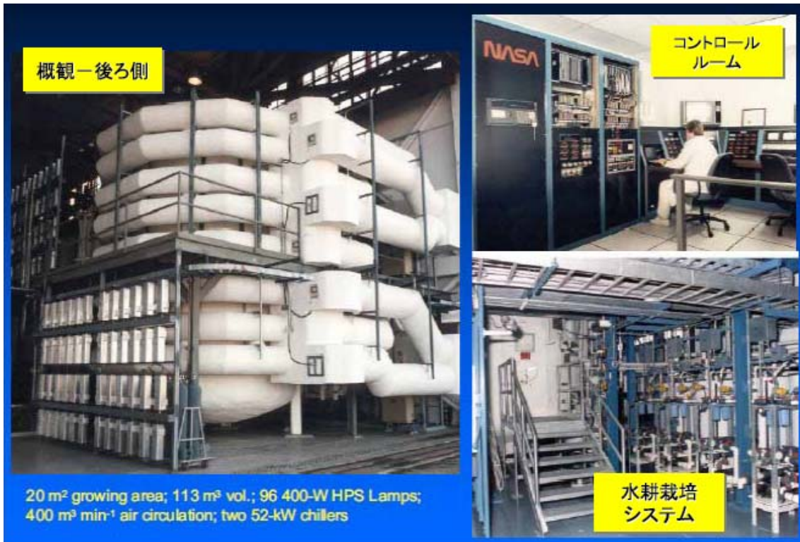
NASA のバイオマス生産チャンバー (Biomass Production Chamber :BPC) : 出典 NASA
