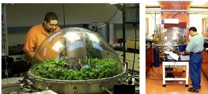
NASA 研究者による低圧環境でのレタス栽培実験 : 出典 NASA
