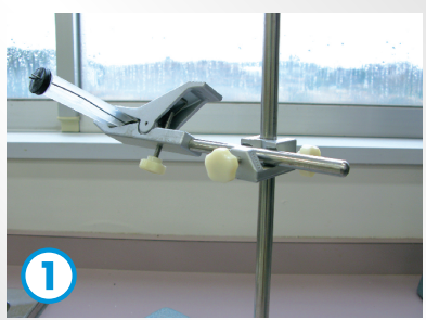
ピストンの部分をスタンドに固定して発射台とする
