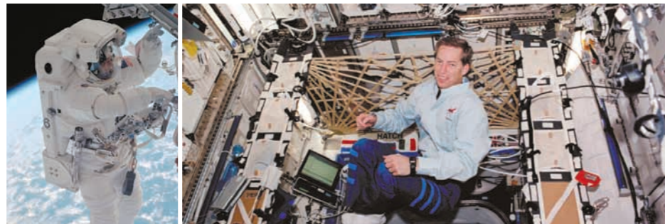
[左]宇宙服の重さは、なんと約120Kg! 強い放射線や地球の周りを高速で回る宇宙ごみから身を守るため、丈夫なつくりになっています。背中には酸素の入った生命維持装置。ヘルメットに内蔵されたマイクやヘッドホンで船内との通信をおこないます [右]アメリカの実験棟「デスティニー」の船内で浮かぶクルー。重力が働かないので物は浮かんだまま。宇宙食がパックされているのも散らばらないようにするためです。また、無重量環境ではクルーたちの筋肉や骨が弱くなってしまいますので、毎日トレーニングマシンなどで鍛えます
