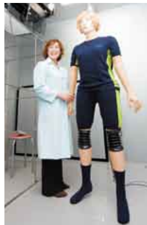
センサーが組み込まれたマネキンに宇宙普段着を着せて、さまざまなデータを集めた。
