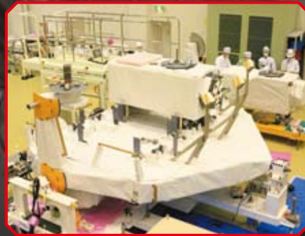
船外パレット 船外の実験で使う機械などを保管する場所。
