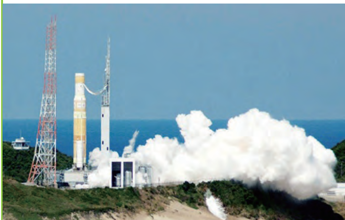
H- II Bの燃焼試験は、150秒間行われた。試験は、ロケットの 先端にあたるペイロード・フェアリングがない状態で行われた。
