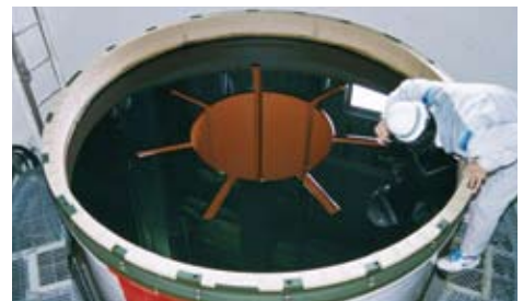
M-V ロケットに固体燃料(黒く見える部分)をつめたところ。
