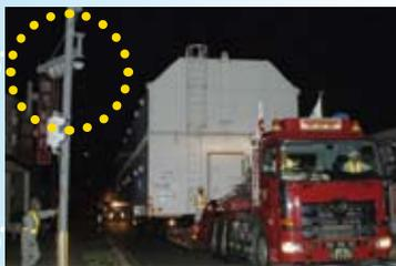
ロケットや人工衛星をのせた大きなトラックが通れるように、信号機は道に平行に曲げられるようになっている。
