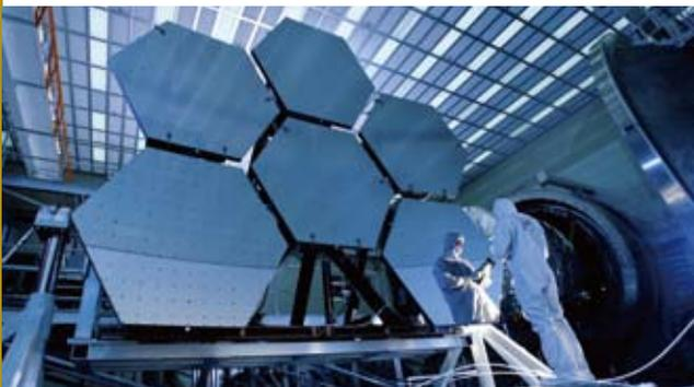
反射鏡 18 枚のうち 6 枚の試験を終えたところ。提供：NASA
