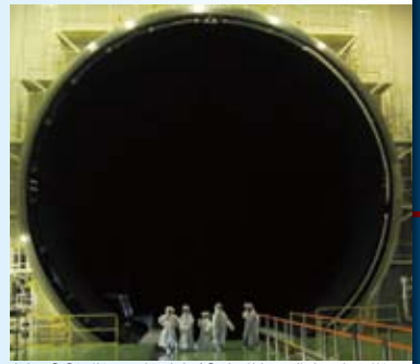
人工衛星の熱真空試験を行う直径13mのスペースチャンバーを見学。場所：筑波宇宙センター (茨城県つくば市)
