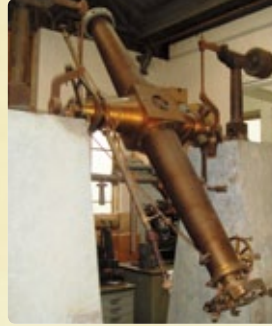
←星の方位を表す赤経の測定に使われたレプソルド子午儀。
