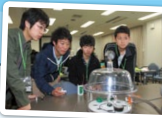
←真空試験中の缶サット。 ↓バルーンを使って、上空から落下するときのデータもとって調べた。
