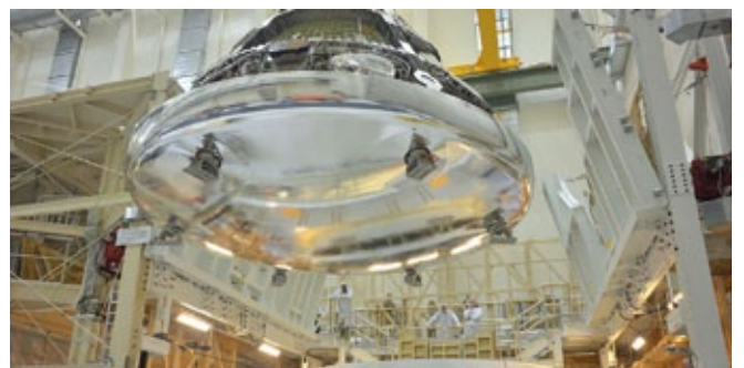
高熱から船内を守るシールドを取り付けた「オリオン」。提供: NASA/Rad Sinyak
