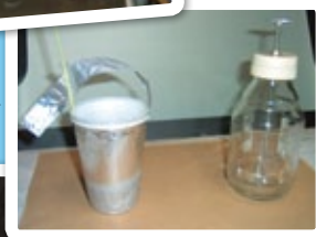
↑左は、静電気をためるライデンびん、右は、2枚のアルミはくの開き方から静電気があるかないか調べる事ができるはく検電器。
