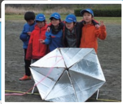
←アンゲル材に金あみを張ったコーナー反射鏡。
