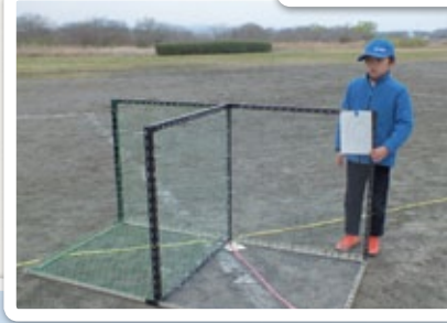
←アンゲル材に金あみを張ったコーナー反射鏡。
