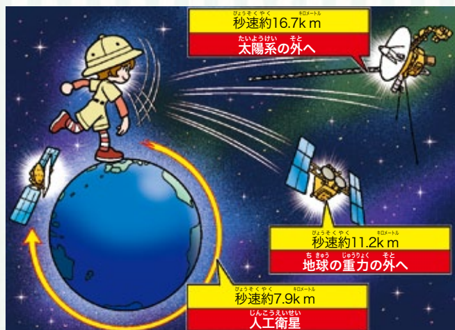
↑宇宙機をどんな軌道にのせるかによって、打ち上げ時の速度が変わる。
