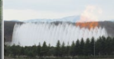
液体水素の燃焼処理
