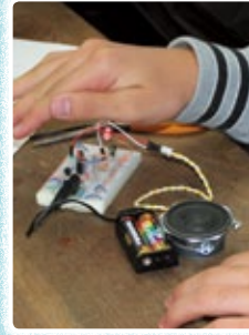
↑ブレッドボードに部品をさして「ルクスサウンダー」の回路をつくったよ。
