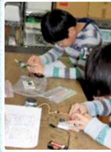
↑ブレッドボードに部品をさして「ルクスサウンダー」の回路をつくったよ。
