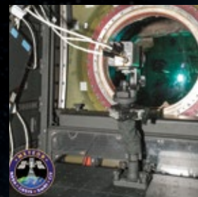
↑写真5: ISSのアメリカの実験棟「デスティニー」の観測窓の前に設置されたメテオカメラ。
