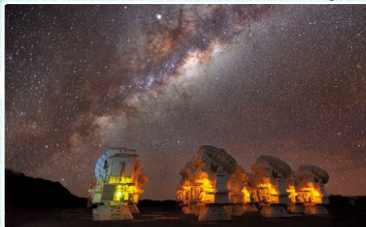
↑南アメリカ・チリの標高5000mのアタカマ砂漠に建設されたアルマ望遠鏡。66台のパラボラアンテナをつなぎ、一つの巨大な電波望遠鏡をつくり出します。
