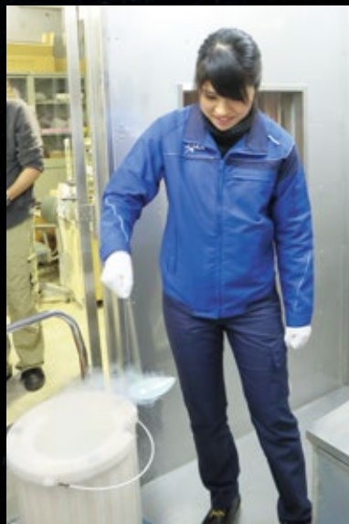
↑「H-IIロケット」8号機の火災発生を受けて、再発防止策を検討するために試験を実施した。液体酸素を使った試験をしている様子。
