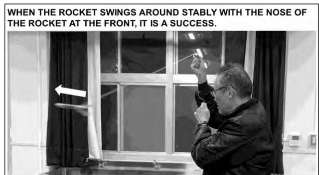
(図5) モデルロケットのスウィングテスト
