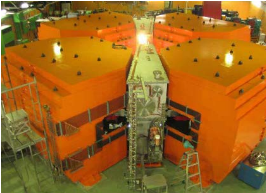
固定加速器波数型リングサイクロロン(fRC) (提供:理化学研究所)
