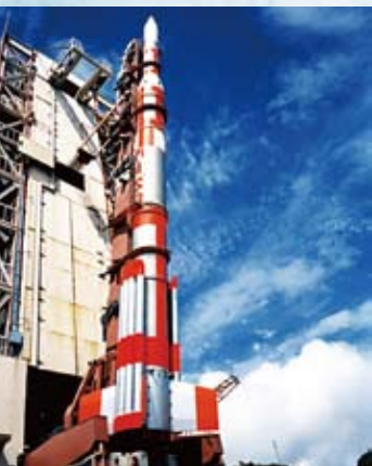
L-4S型ロケット5号機 全長16.5m、重量9.4t。人工衛星を打ち上げたロケットとしては世界最軽量。
