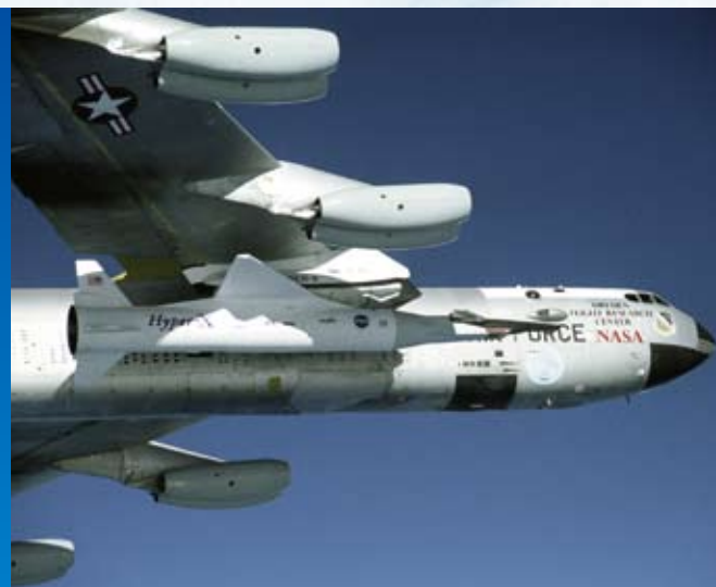
X-43 ロケットを機体の横に下げ、空中で発射する。 提供：NASA
