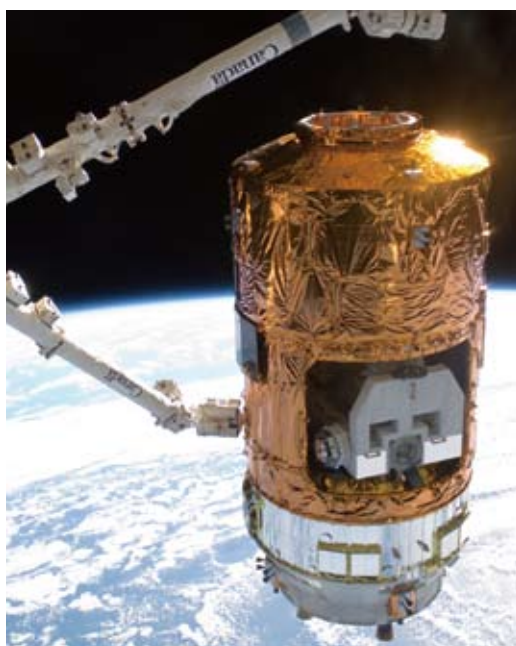
ISS のロボットアームにつかまれる宇宙ステーション補給機「こうのとりの」2号機。提供：NASA
