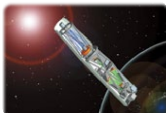
↑CLASPのしくみ。観測装置が落ちてくるまでの約300秒間で観測する。
