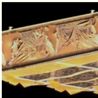
↑宇宙環境により浸食を受けたISS太陽電池パドルの表面材料。右は拡大。
