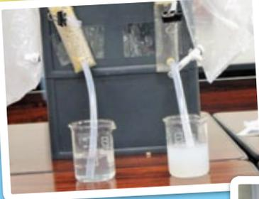
→手回し発電機を回して水を電気分解して酸素と水素を作り出す!
