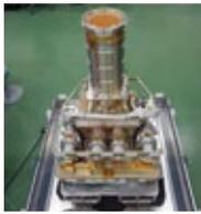
低いエネルギーのX線をとらえて画像を撮影する。今までのX線天文衛星に搭載されたCCDカメラでは最大の視野を持つ。
