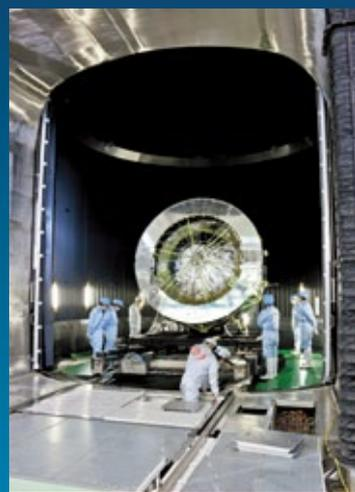
↑直径8mのスペースチャンバでH-II Aロケット高度化の試験を行う様子。
