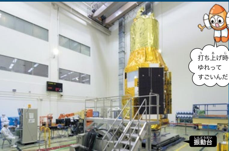
↑大型振動試験設備でX線天文衛星「ひとみ」(ASTRO-H)を試験する様子。
