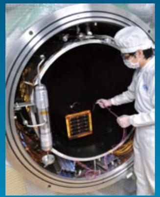
スペースチャンバを担当しています。環境試験の中で最も多く不具合が発生するのが、宇宙空間の真空と熱を再現した環境での試験です。高熱と低温を何度も繰り返すので長いものでは1か月くらいかけて、宇宙機や搭載機器の不具合を洗い出していきます。種子島宇宙センターで打ち上げを見る時は、「自分が手がけた宇宙機が巣立っていくんだ！」と感動しますね。
