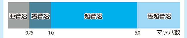
亜音速は音速よりおそい。遷音速は音速よりおそいが、一部に超音速が存在する。超音速、極超音速は、音速より速い。
