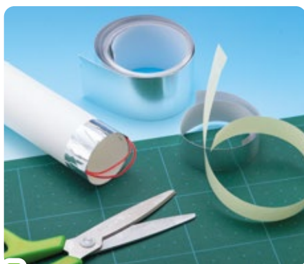
5 アルミテープを25cmくらいの長さに切り、半分のはばに切る(太いとよく飛ばないことがあるため)。
