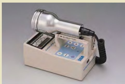
ガイガー・ミュラー計数管の製品例。GM サーベイメーター TGS-146B（アロカ株式会社）。
