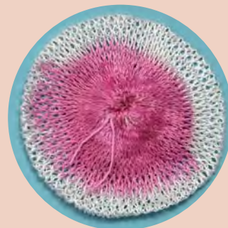
▲マントル。インターネットの情報で放射線が出る”といわれているメーカーのマントルを 2 種類購入して試してみましたが、いずれの場合も放射線の軌跡を見ることができなかった。
