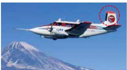
航空機には、機体の後側に垂直尾翼と呼ばれる翼がついています。この垂直尾翼による、風見安定の効果で、航空機は安定してまっすぐに飛ぶことができます。
